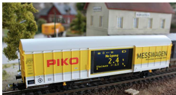
Neigungsmessung bei Überhöhungen in Prozent
